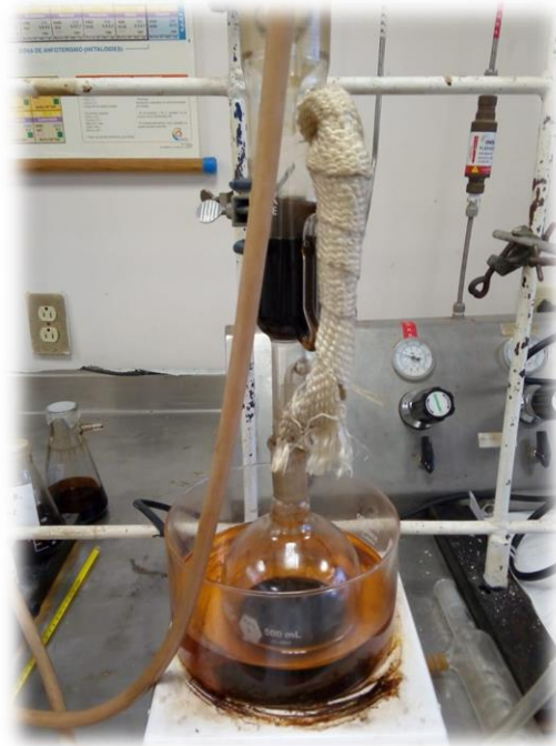
Figura 3.2 Equipo de extracción Soxhlet usado para la extracción de asfáltenos.
