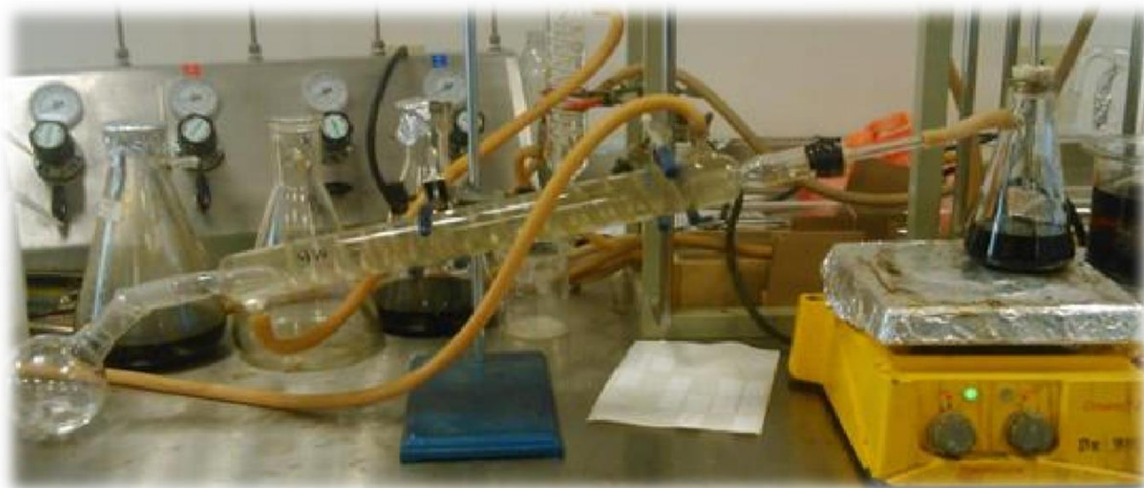
Figura 3.3 Sistema para la destilación del tolueno.
