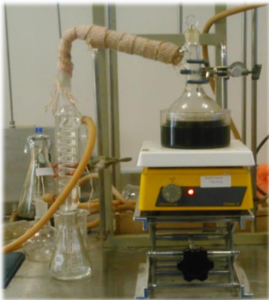
Figura 3.5 Sistema para la destilación de n-heptano..
