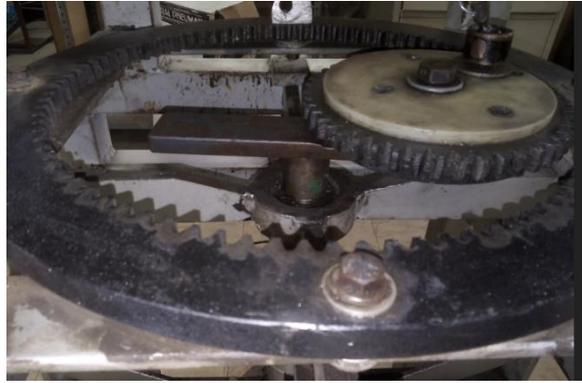
**Figura 4.1 Mecanismo de movimiento de rotación de la prótesis**
