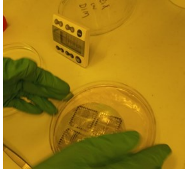
Figura 43. Colocación de oblea en líquido revelador.
