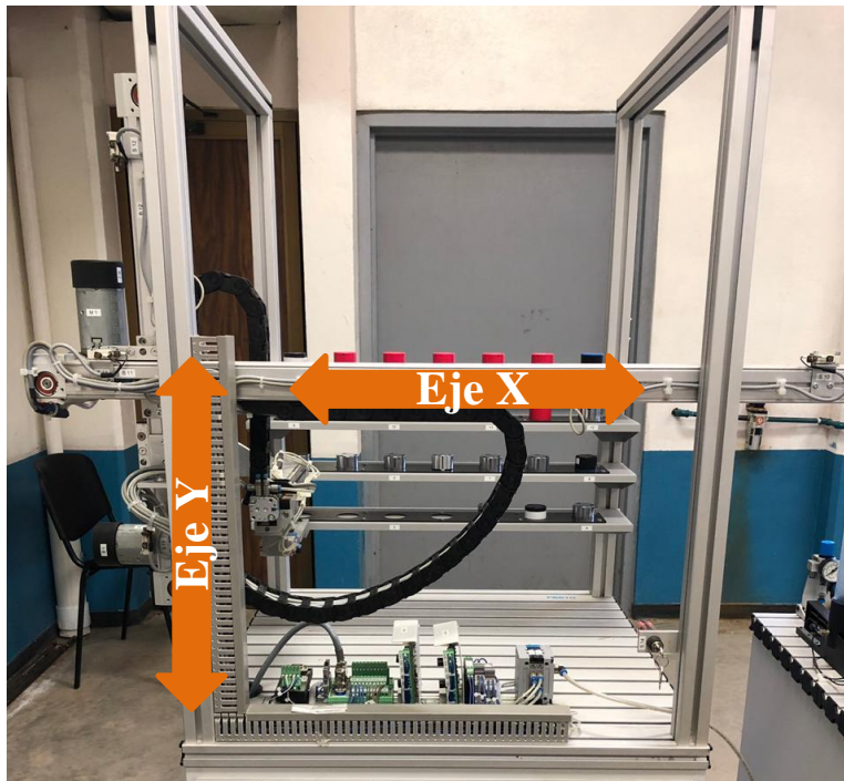
Imagen 35. Eje X y Y, realizan los movimientos a las distintas locaciones de la matriz de los insumos.
