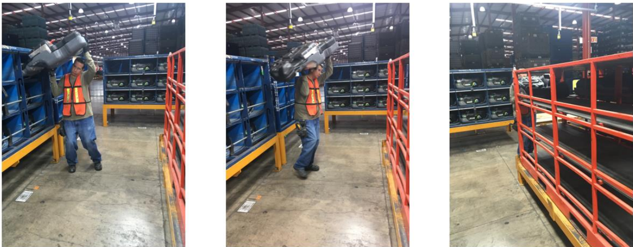
Imagen 1. Traslado de tanque de gasolina con sistema no automatizado.
