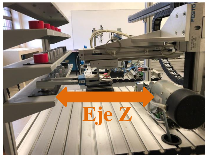
Imagen 34. Eje Z, ejecuta el movimiento de extracción de la pieza.
