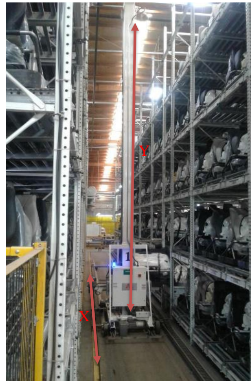
Imagen 20. Libertad de movimientos de carro transportador de asientos X y Y.
