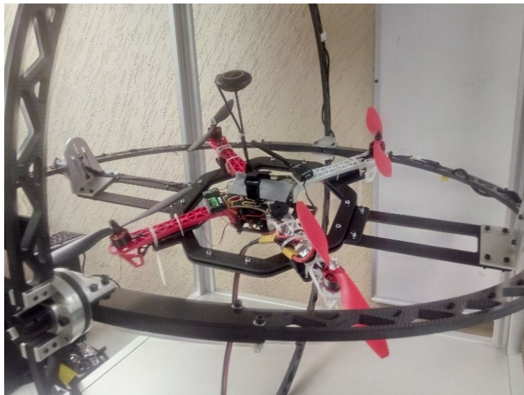
Figura 4.3: VANT montado en la plataforma de pruebas.
