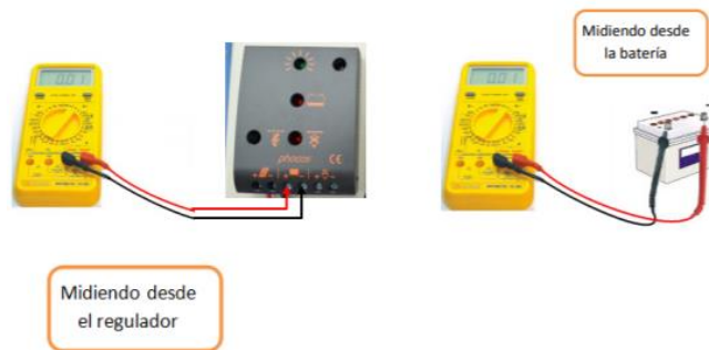
Figura 58. Verificación de voltaje almacenado en Regulador y Batería
