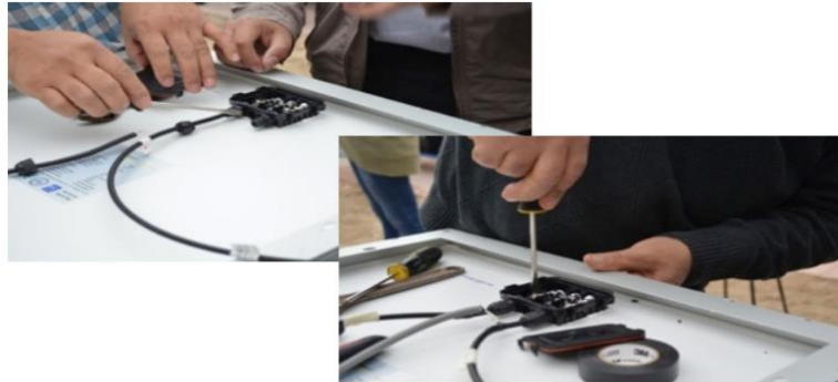
Figura 53. Identificación de polaridad en paneles solares
