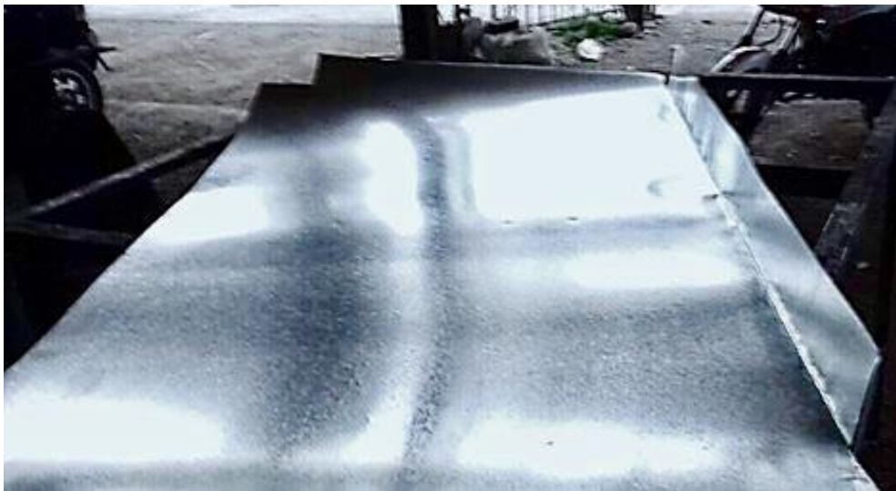
Fig.16. Construcción de la Caja del Destilador Solar.
