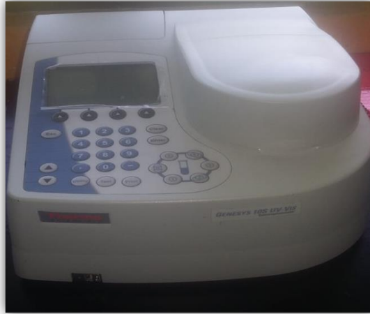
Figura 11. Espectrofotómetro modelo THERMO SCIENTIFIC GENESYS 10S Vis.
