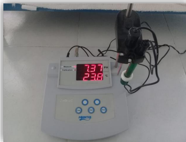
Figura 12. Potenciómetro equipado con un electrodo de vidrio y de referencia.
