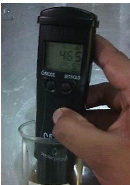
Figura 13. Determinación de CE mediante un dispositivo Waterproof Hi™.
