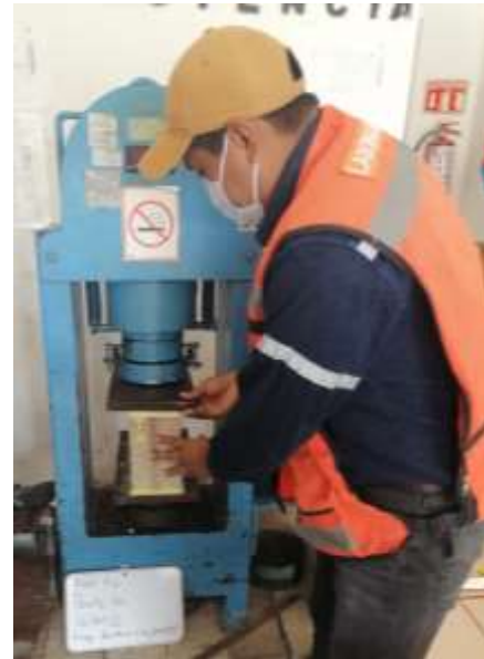
Figura 61.- Colocación de placa superior. (Autor Propio, 2021)
