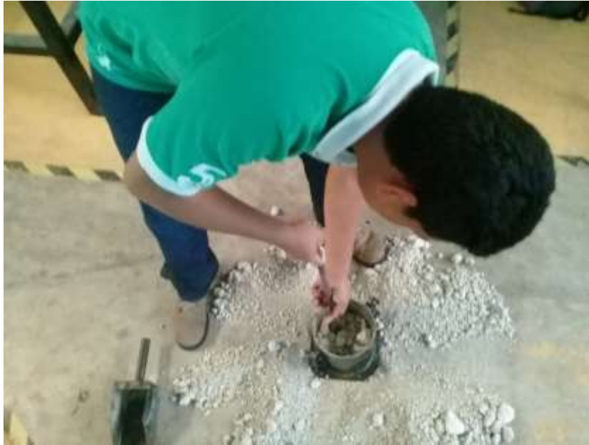
Figura 45.-Utilización de la varilla punta de bala para compactar el tepezil. (Autor Propio, 2019)
