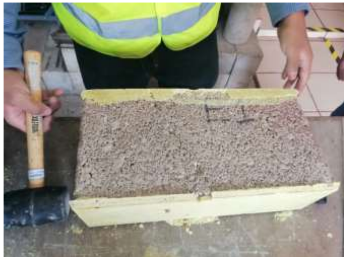
Figura 64.- Identificación de la falla en el block. (Autor Propio, 2021)
