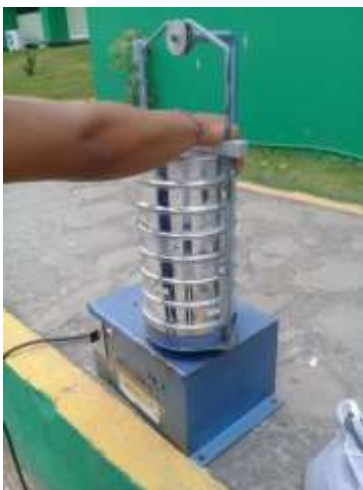
Figura 40.- Tamizado del Tepezil. (Autor Propio, 2019)
