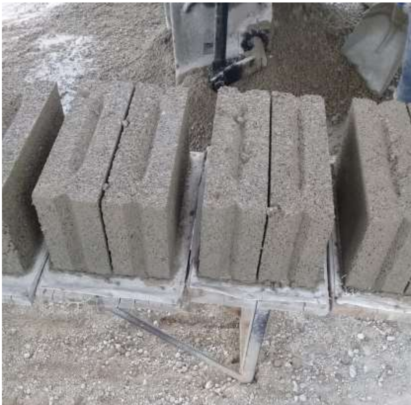
Figura 24.- Block sobre base de madera listo para su traslado al área de secado. (Autor Propio, 2019)
