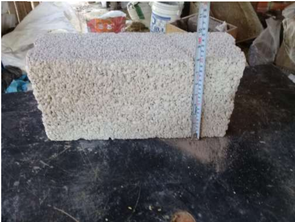
Figura 49.- Medición del alto del block de Tepezil. (Autor Propio, 2019)
