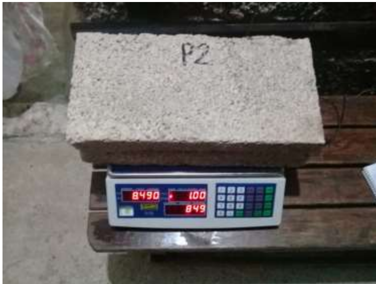
Figura 50.- Obtención del peso del block de Tepezil en estado seco. (Autor Propio, 2021)
