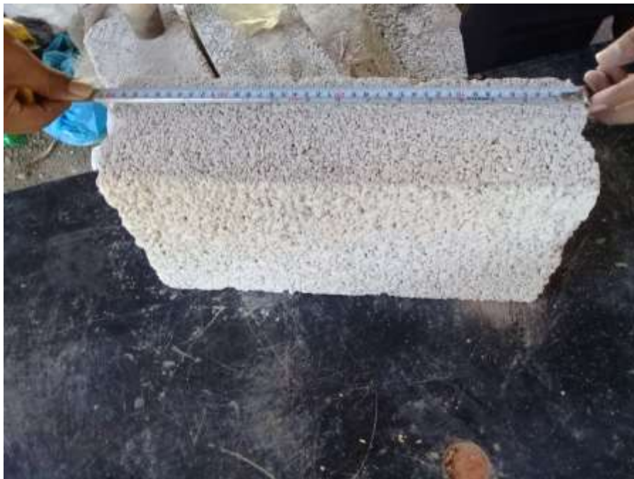
Figura 47.- Medición del largo del block de Tepezil. (Autor Propio, 2019)
