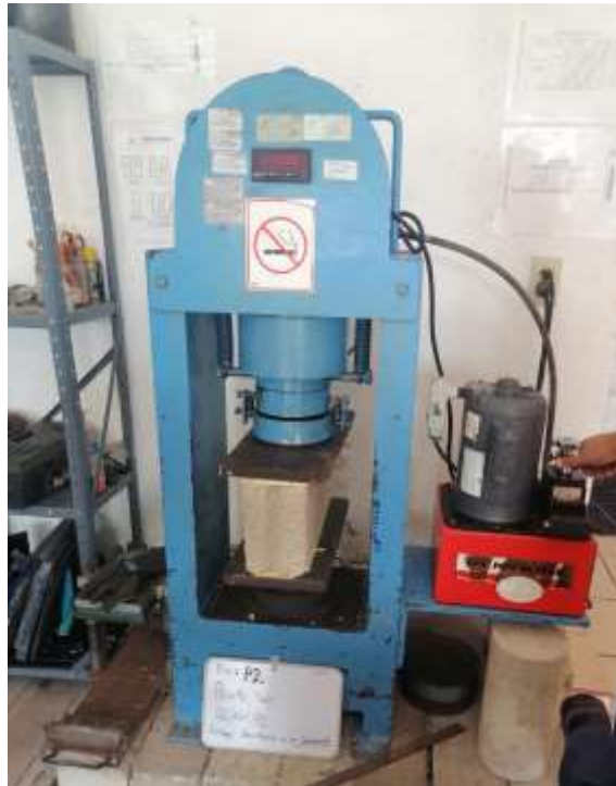
Figura 63.- Momento en que el block falla sobre la carga. (Autor Propio, 2021)
