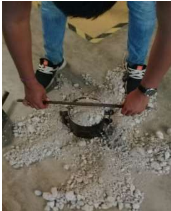
Figura 46.-Utilización de la varilla punta de bala para enrasar el tepezil. (Autor Propio, 2019)
