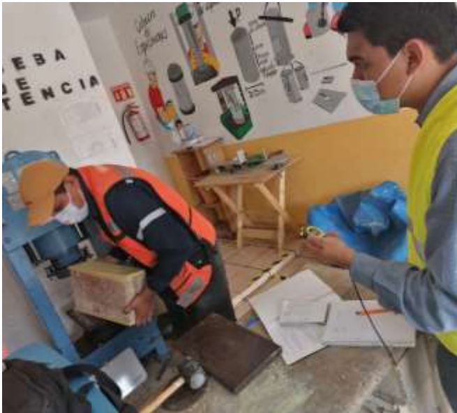
Figura 60.- Colocación del block. (Autor Propio, 2021)
