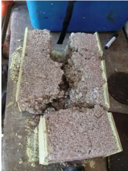
Figura 65.- Block de Tepezil, después de habersele aplicado una carga. (Autor Propio, 2021)
