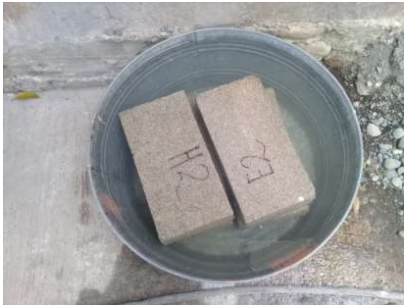
Figura 51.- Block de Tepezil sumergido en agua. (Autor Propio, 2021)
