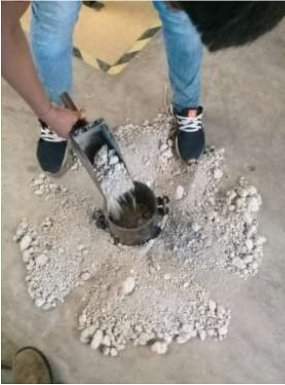
Figura 43.- Vaciado del Tepezil en el recipiente. (Autor Propio, 2019)
