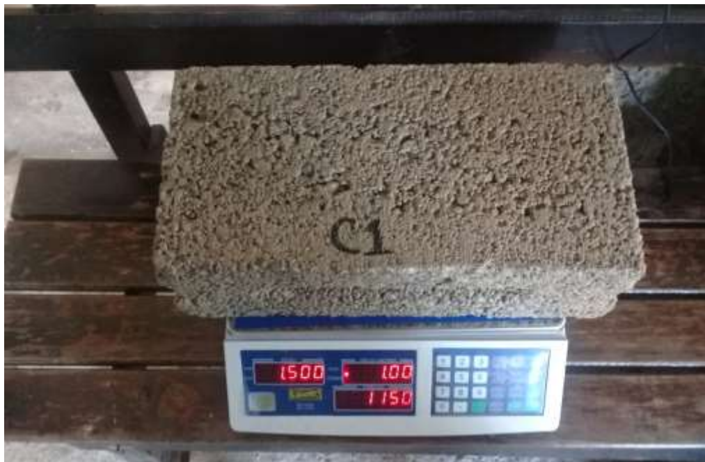
Figura 52.- Obtención del peso del block de Tepezil después de ser retirado del contenedor de agua. (Autor Propio, 2021)
