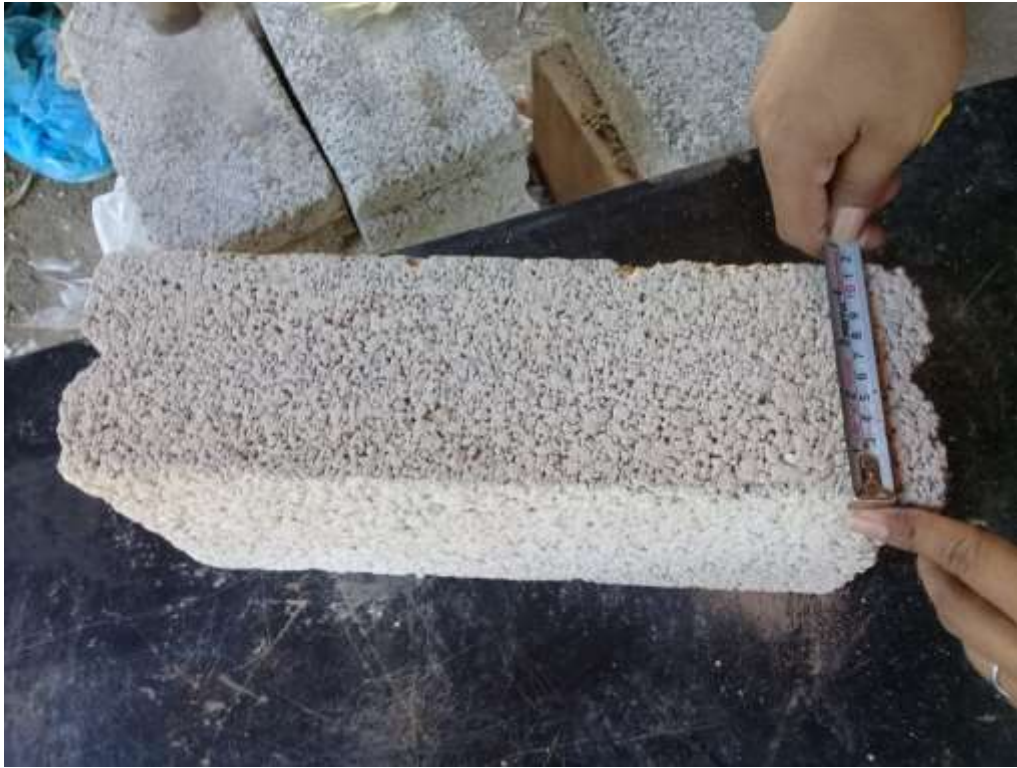
Figura 48.- Medición del ancho del block de Tepezil. (Autor Propio, 2019)
