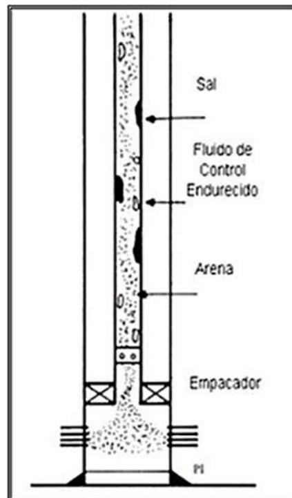
Figura 2. 33 Tubería taponeada con arena, sal y fluidos.
