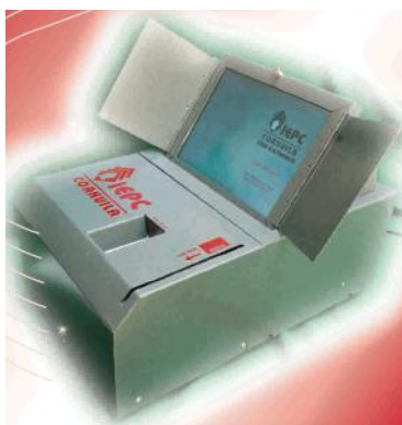
Figura 2.11 Prototipo de urna electrónica del IEPC del Estado de Coahuila (Instituto Electoral de Distrito Federal, 2005)
