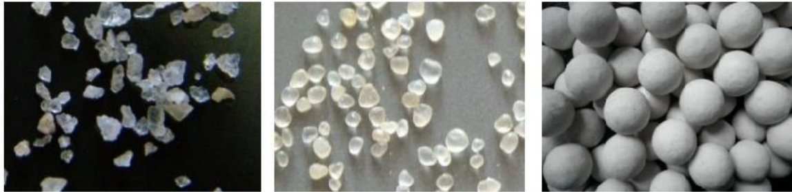
Ilustración 12 Esfericidad y redondez de arena(izquierda), arena recubierta con resina(intermedio), cerámicos(derecha)(Navarro,2017)
