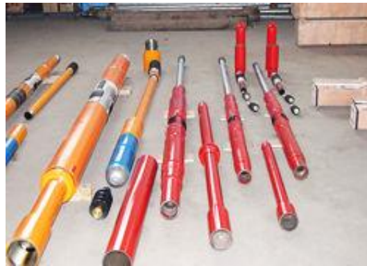
Fig. 2.18 Colgador de liner (Zaldivar,C.D., 2017).
