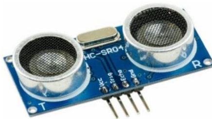
Figura 18. Sensor ultrasónico HC-SR04.
