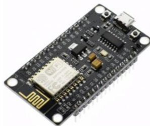
Figura 16. Módulo ESP8266 V3.
