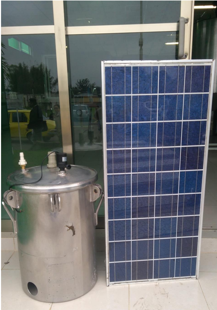
Figura 13: Fotocelda con tanque de almacenamiento.
