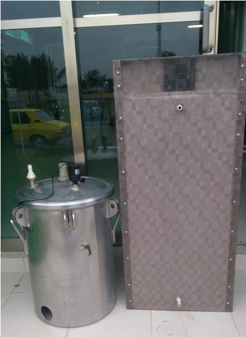
Figura 14: Intercambiador de calor y tanque de almacenamiento.
