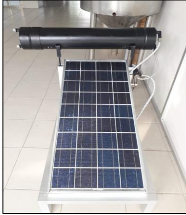
Figura 12: Fotocelda solar con calentador solar integrado.
