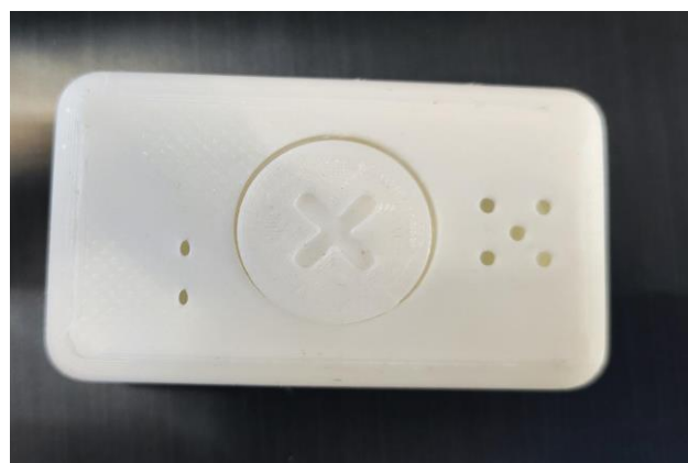
Figura 4-29: Partes unidas de la carcasa impresa del dispositivo
