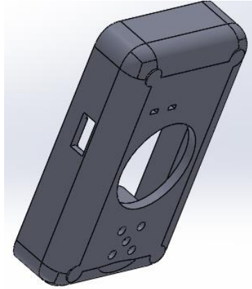
Figura 4-24: Segunda versión de la carcasa parte frontal vista desde la parte inferior
