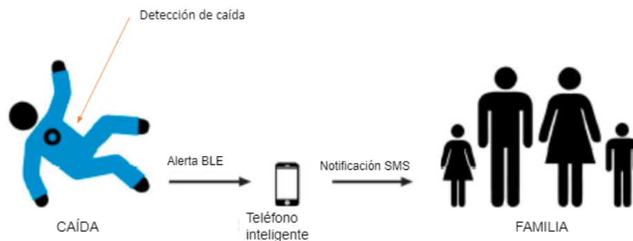
Figura 7-45: Funcionamiento del sistema
