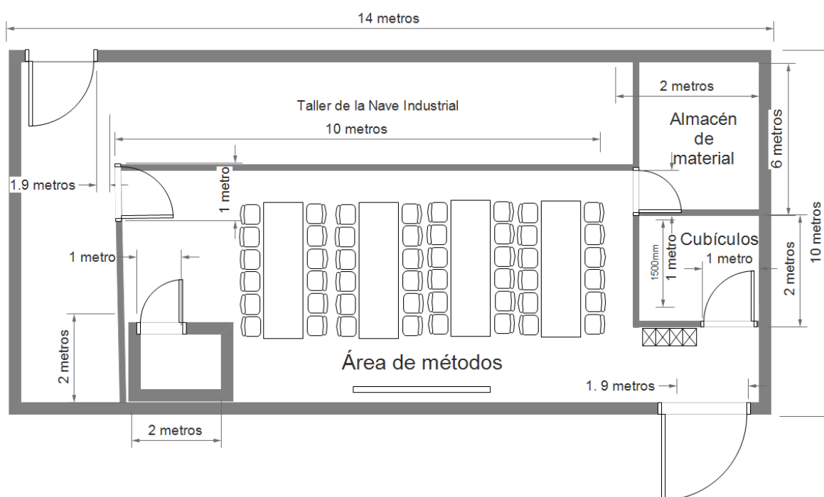
Figura 4.1 Layout del área de métodos de la nave industrial.
