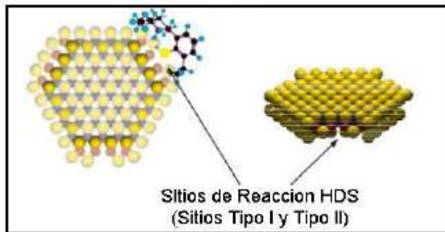
Figura 2.6. Sitios de Reacción HDS de Co (Ni)-Mo-S Tipo I y Tipo II.
