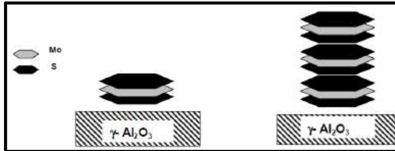
Figura 2.5. Representación esquemática del modelo Co (Ni)-Mo-S a) Tipo I y b) Tipo II.
