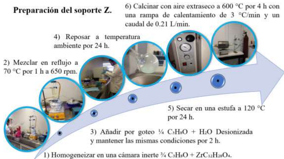
Figura 3.2 Esquema de la preparación del soporte Z.
