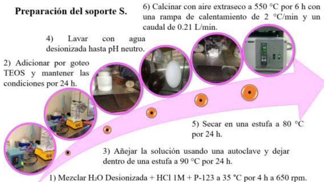
Figura 3.3 Esquema de la preparación del soporte SBA-15.
