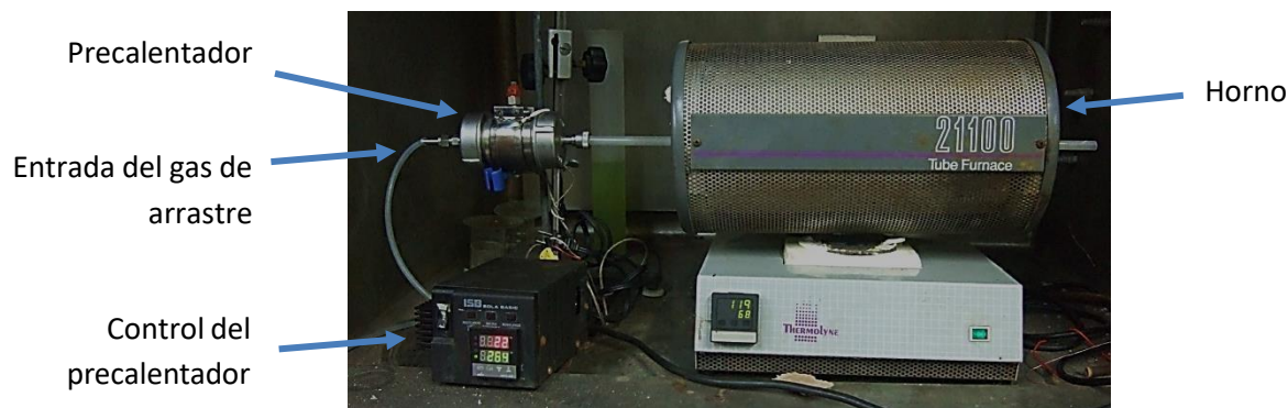
Figura 14. Esquema del equipo utilizado en la síntesis de NTC.
