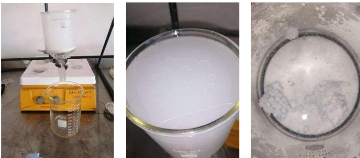
Figura 18. Etapa de purificación de moléculas: a) Filtración a baja temperatura, b) Separación de fases en medio acuoso, c) Formación de ceras.
