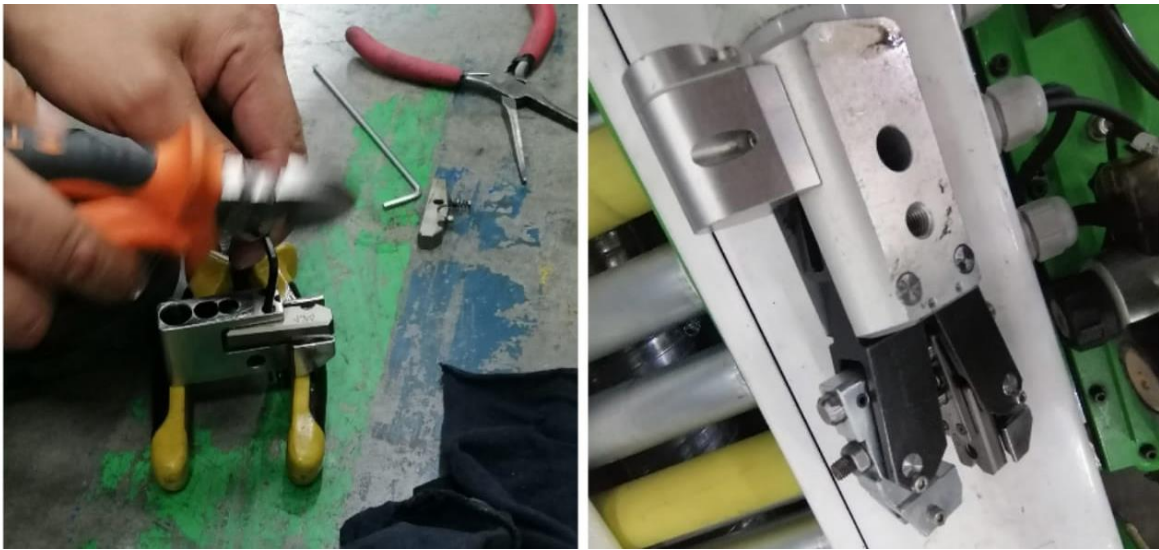
Figura 36. Retiro de pernos para despegar pistola LOKRING.
