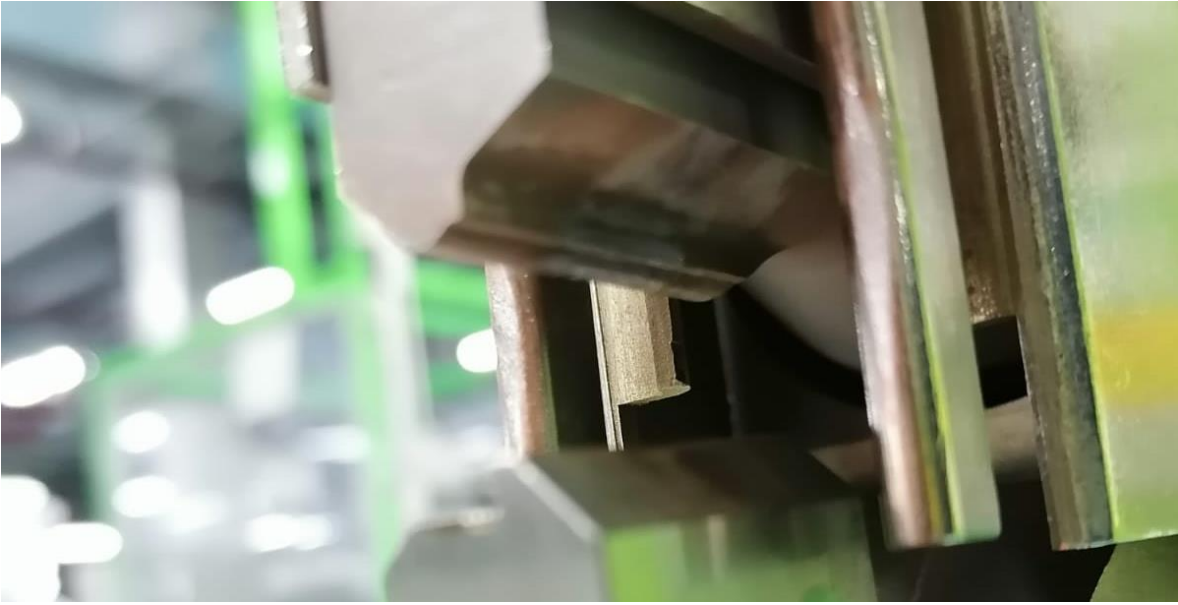
Figura 31. Desgaste de sonotrodo por operación.
