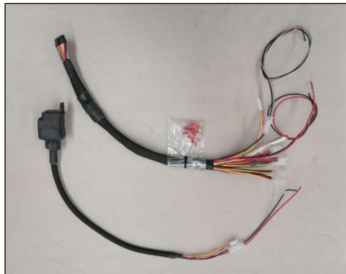
Fig. 8. Arnés relevador y arnés de alimentación para la aplicación Sak-Gal-C2-MAG1.
