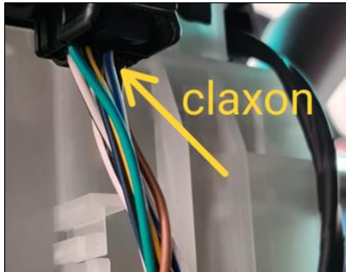
Fig. 10. Fotografía para identificar el cable del claxon en la columna del volante de un vehículo Foton Auman 245.
