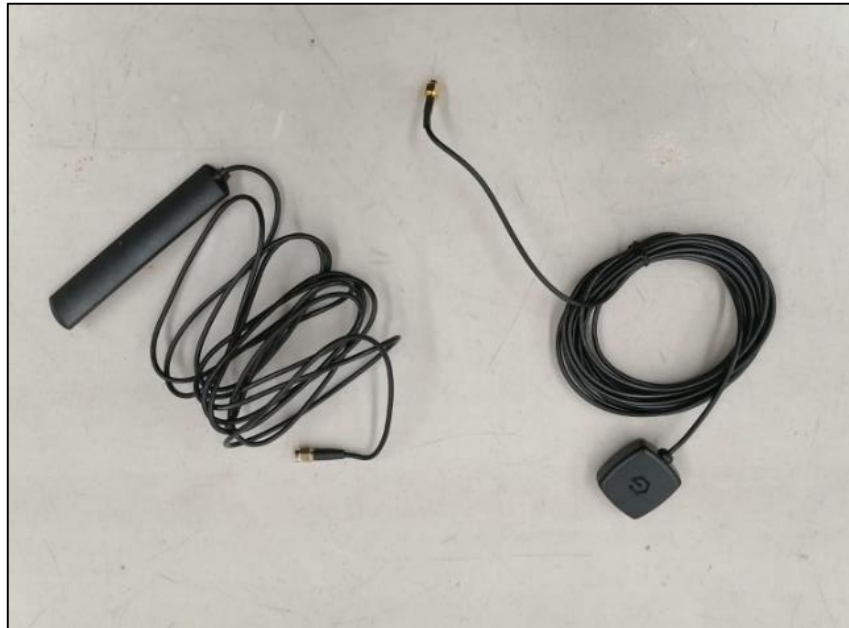
Fig. 13. Antenas GSM y GPS para la aplicación Sak-Gal-C2-MAG1.
