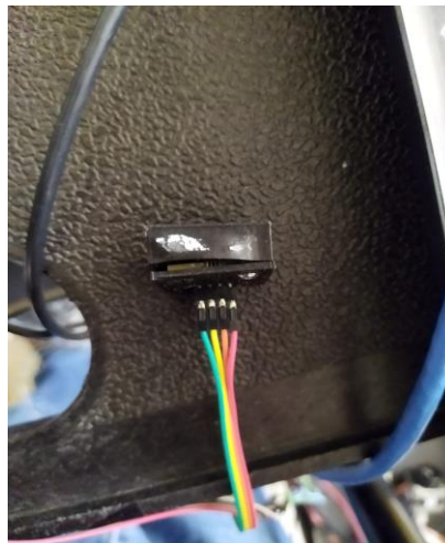
Figura 22 Conexión de ADXL203 para ejes X e Y.
