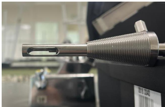
Figura 3. Termopar de la sonda del analizador de gases de combustión
