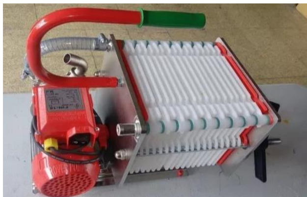
Figura 28. Filtro prensa de placas para separación de flujos a presión.
