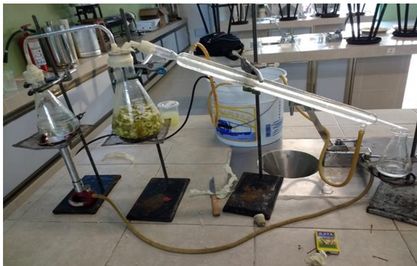
Figura 12. Equipo de destilación para la extracción de aceites esenciales.
