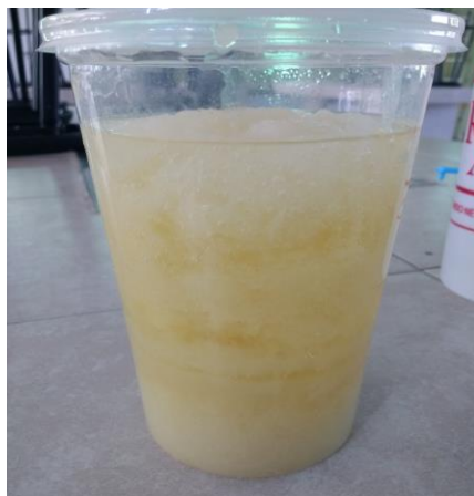
Figura 17. Pectina en etanol de 96° GL para su precipitación.
