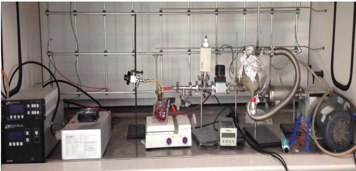
Figura 2.3 Oxidación de fibra de carbono por tratamiento con plasma de oxígeno.
