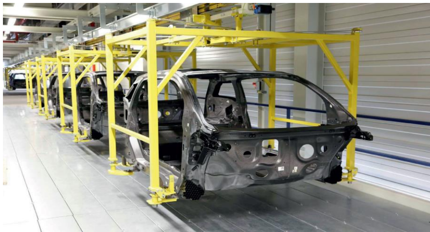
Figura 1.4 Monocasco de Modelo i3 de la marca BMW en el que son empleados CFRP [33].
