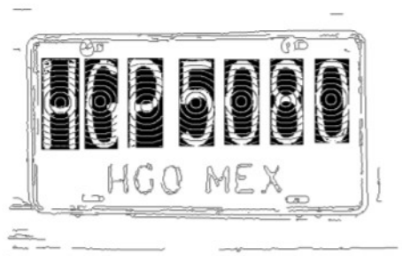
Figura 1.21: Reconocimiento de caracteres en base a su codificación radial. Fuente: Imagen cortesía de [Sucar and Gómez, 2018]
