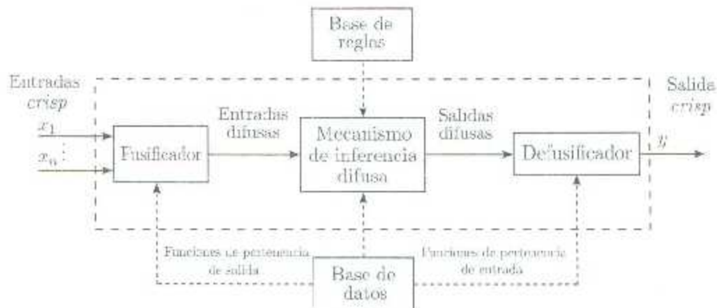
Figura 3.9: Diagrama a bloques de la estructura general de un sistema difuso.
