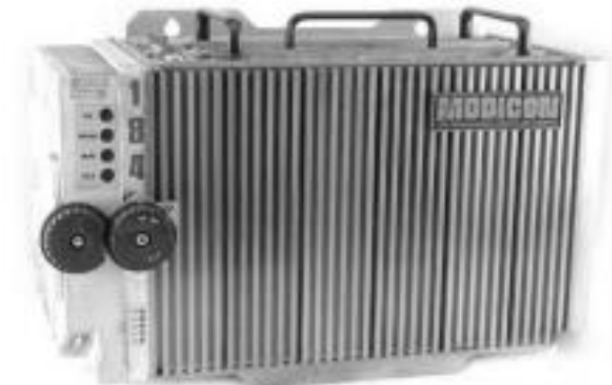
Figura 2. Modicon 184, segundo controlador programable de Modicon en 1973. Fuente: (Vanessa Romero Segovia, 2013).
