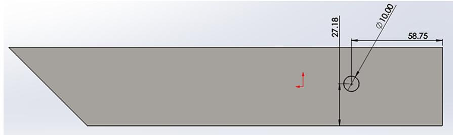
Figura 3.21. Diseño del soporte central con orificio para chumacera y corte a 45° para su conexión a la estructura superior. Fuente: Elaboración propia (2022).
