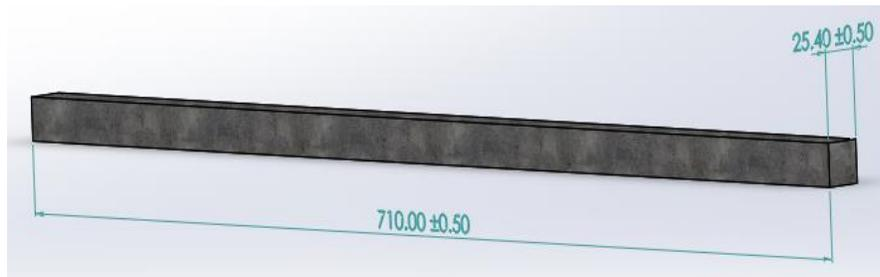
Figura 3.34. Primer diseño del eje. Fuente: Elaboración propia (2022).
