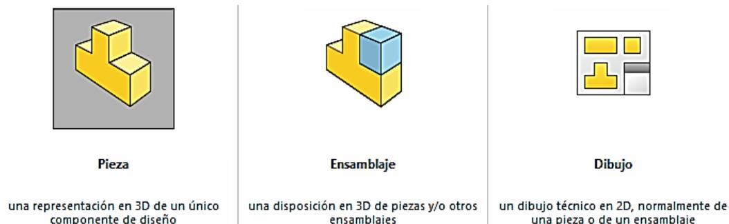
Figura 2.4. Módulos existentes en SolidWorks. Fuente: SolidWorks 2018 (2022).
