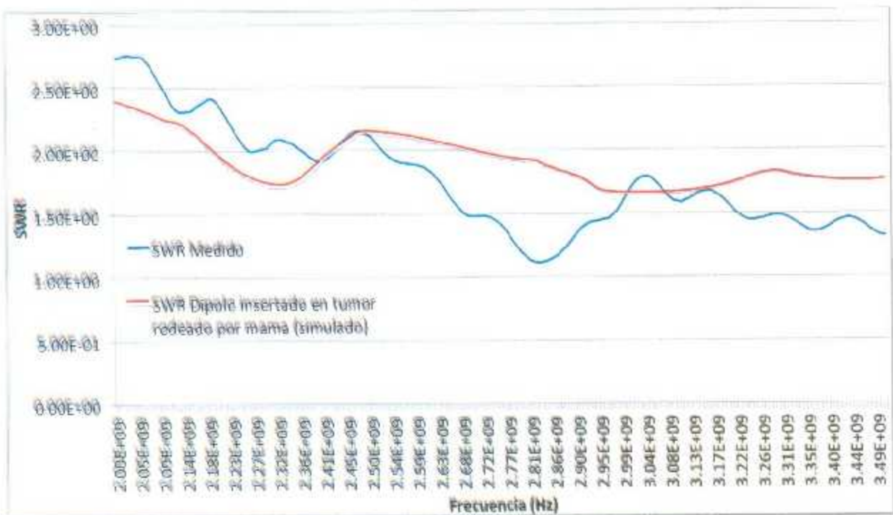
Figura 6.16 Gráfica del SWR obtenido de la medición de un aplicador de tipo dipolo insertado en un tumor rodeado por tejido mamario sano.
