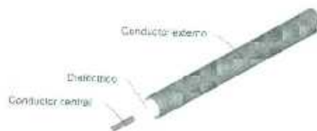
Figura 4.1 Esquema de un cable coaxial UT-085 en el cual se señalan sus tres componentes: conductor externo, dieléctrico y conductor interno.
