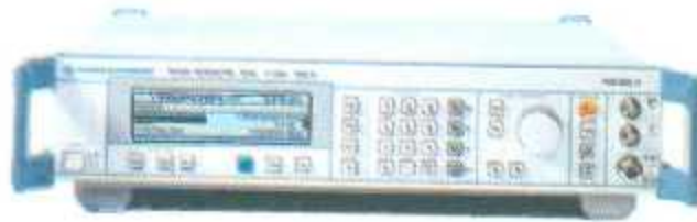
Figura 5.38 Equipo de radiación electromagnética Rohde & Schwarz SML03, que se utilizará como generador de microondas a 2.45 GHz.
