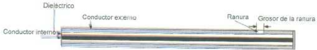
Figura 2.27 Estructura de una antena de ranura no simétrica.
