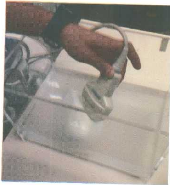
Figura 5.35 Escaneo del phantom de mama que contiene un phantom de tumor utilizando una sonda convexa.
