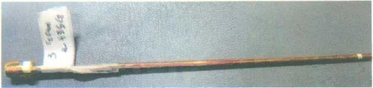
Figura 5.10 Aplicador de tipo dipolo terminado.
