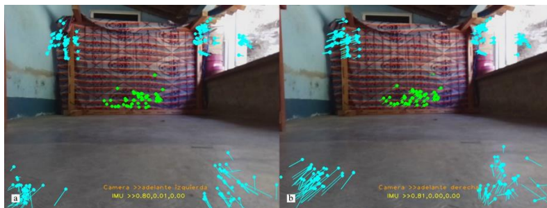
Figura 6.26. Resultados del algoritmo de detección de movimientos en dos dimensiones durante recorridos ejecutados por el carrito de control remoto. a) adelante/izquierda. b) adelante/derecha.
