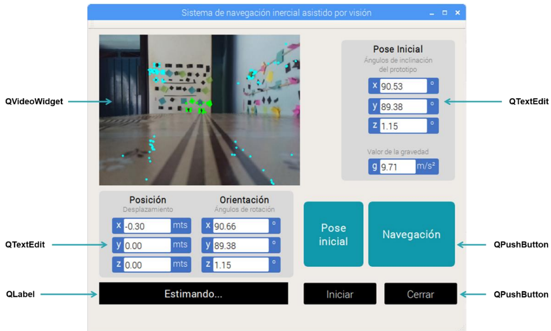
Figura 5.10. Interfaz gráfica del sistema de navegación inercial asistido por visión.
