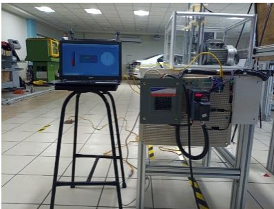
Figura 28. Máquina de Desgaste Pin On Ring desarrollada. Fuente: Elaboración propia.
