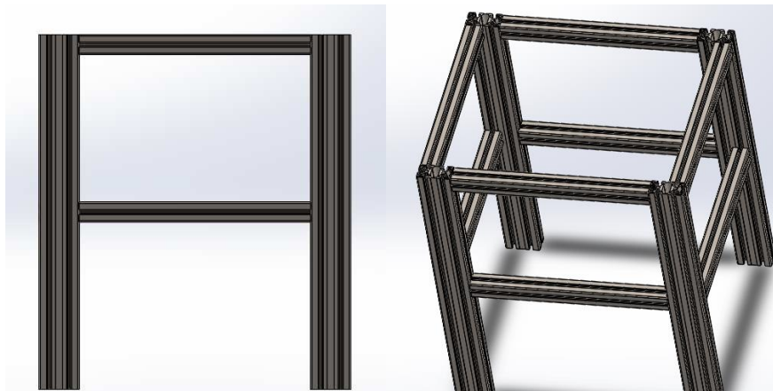
Figura 6. Modelado CAD de la base de perfil Bosch para la máquina de desgaste.
