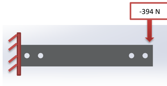
Figura 24. Diagrama de cuerpo libre de las piezas sometidas a simulación. Fuente: Elaboración propia.
