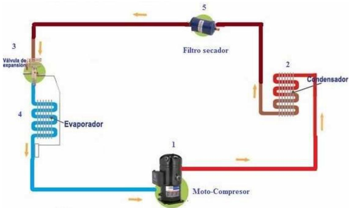
Figura 1. Diagrama sistema de refrigeración convencional (Area tecnologia, 2014)
