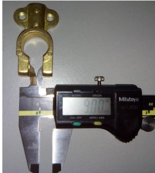
Figura 5.11: Distancia entre terminales de la terminal de batería en milímetros.
