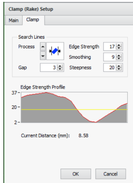
Figura 5.52b: Parámetro para calcular la distancia entre terminales.
