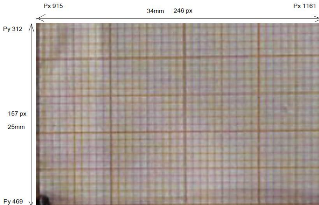
Figura 5.0c: Resolución mínima para el eje x e y.
