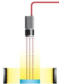
Figura 2.3: Iluminación por dark field.
