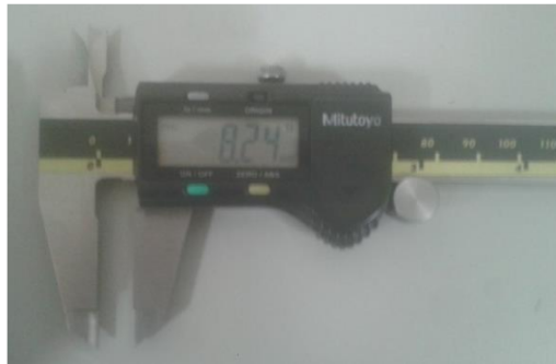
Figura 5.7: Diámetro de los orificios de la base de aceite en milímetros.
