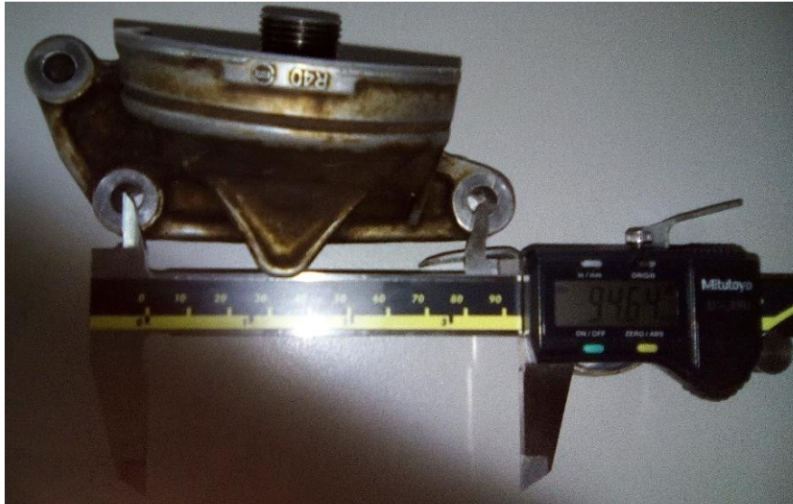
Figura 5.9: Distancia entre el orificio 2 y 3 de la base de aceite en milímetros.
