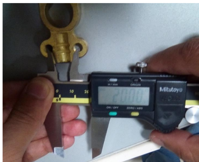
Figura 5.12: Distancia entre orificios de sujeción de la terminal de batería en milímetros.
