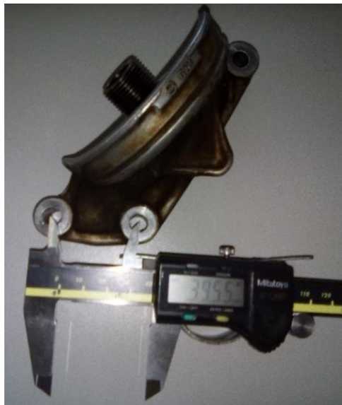
Figura 5.8: Distancia entre el orificio 1 y 2 de la base de aceite en milímetros.
