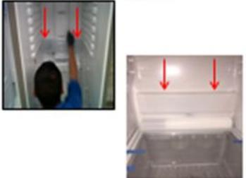
**6.- UNA VEZ COLOCADA LA CUBIERTA VERIFICA QUE ESTE BIEN ENSAMBLADA EN LOS GROMMETS EMPUJANDO LA CUBIERTA HACIA ABAJO.**
