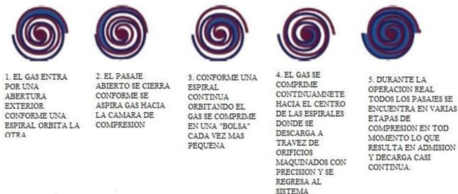
Figura 2.18. Movimiento de las bolsas de gas en el espiral
