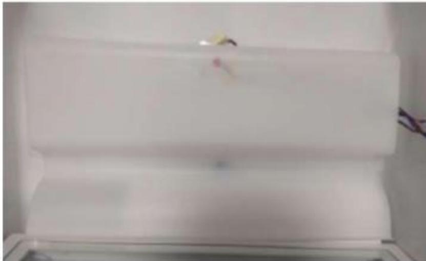
No hay decoloracion en la cubierta del LED ni en sus alrededores y las temperaturas no son excesivas a tal grado de deformar algun material.
