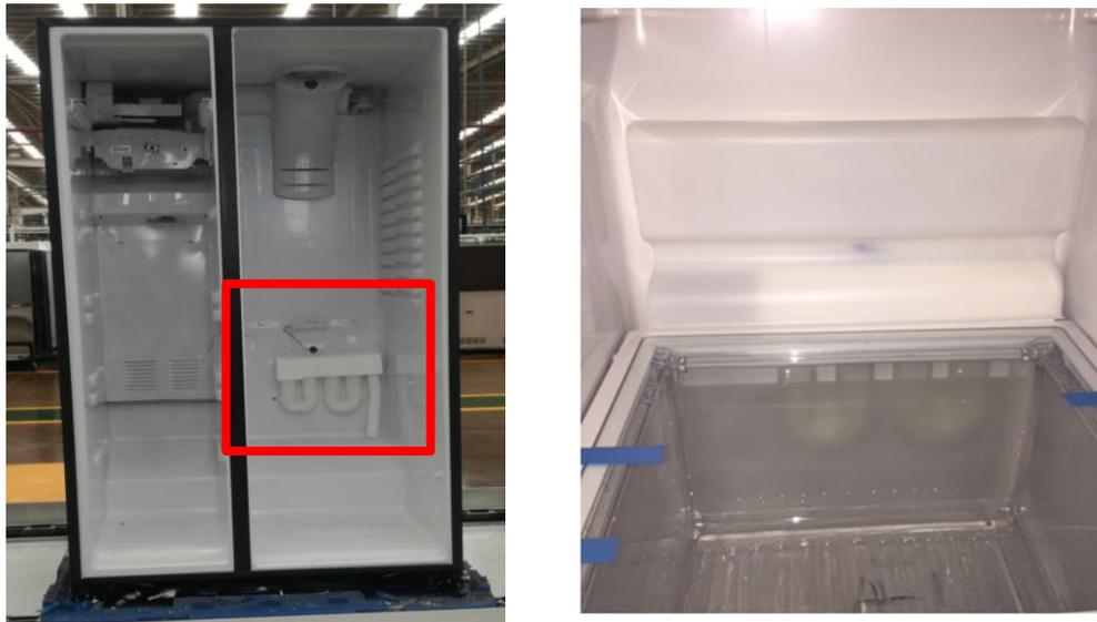
**Figura 5.17.** Evidencia de colocación de escudo de luz media.
