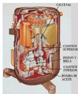
**Figura 2.16.** Partes internas de un compresor hermético soldado.
