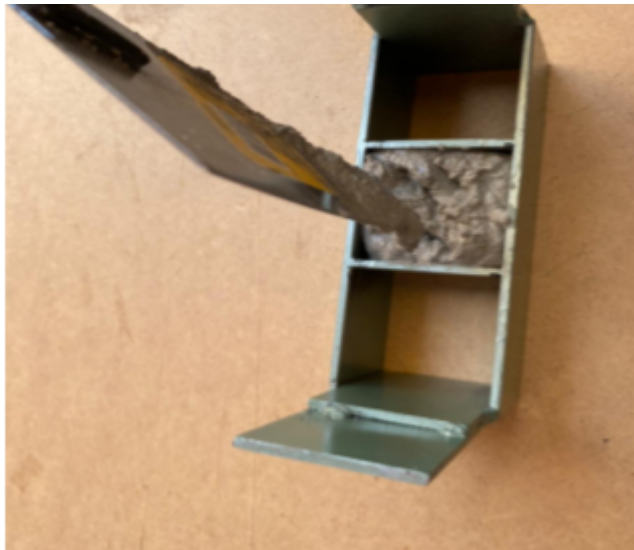
Imagen 25. Vaciado de mezcla en el molde.
