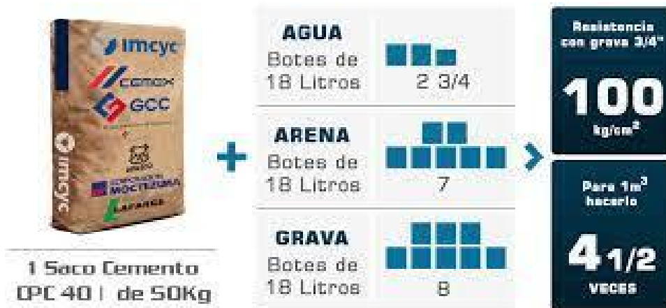
Imagen 38. Dosificación de concreto de una f'c 100 kg/cm 2
