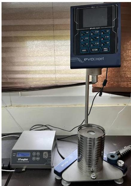
**Figura 2.4** Viscosímetro rotacional
