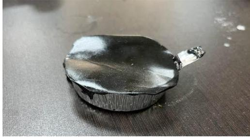
**Figura 2.7** Muestra para prueba de penetración
