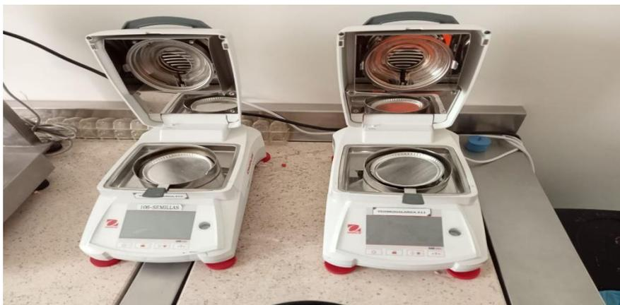
Figura 9.- Equipo muestreador de humedad (KRUPS GX4100).
