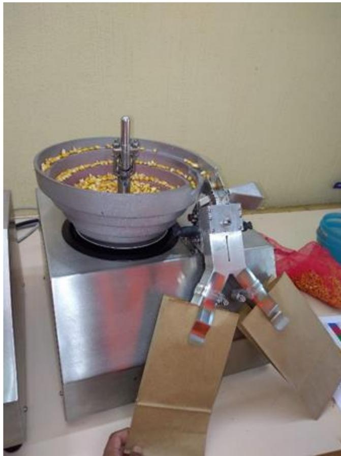
Figura 17.- Contadora de semillas.
