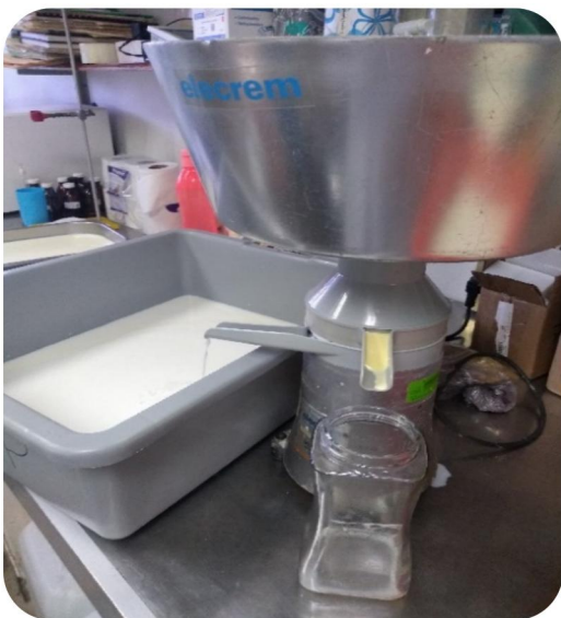
Imagen 1. Se utilizó el equipo Elecrem con capacidad de 10 L para descremar la leche
