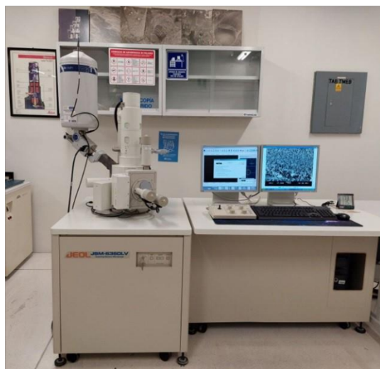
Figura 13 Microscopio Electrónico de Barrido JOEL JSM-6360LV.
