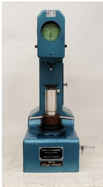
Figura 16 Durómetro Rockwell C Louis Small.
