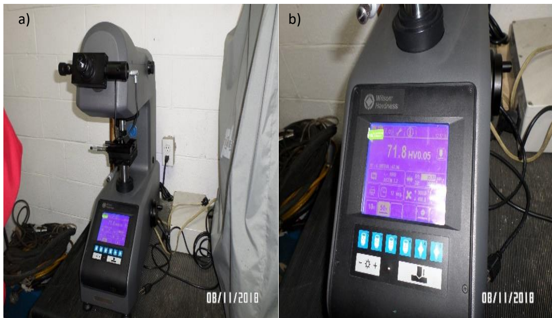
Figura 3.12 a) Durómetro Marca Wilson, y b) Caratula del durómetro indicando la dureza alcanzada
