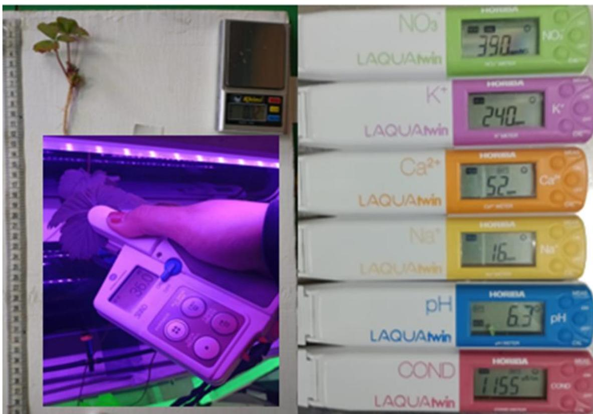
Figura 8 Medición de variables: peso fresco, altura de la planta, longitud de raíz, clorofila, número de hojas y medición de iones.
