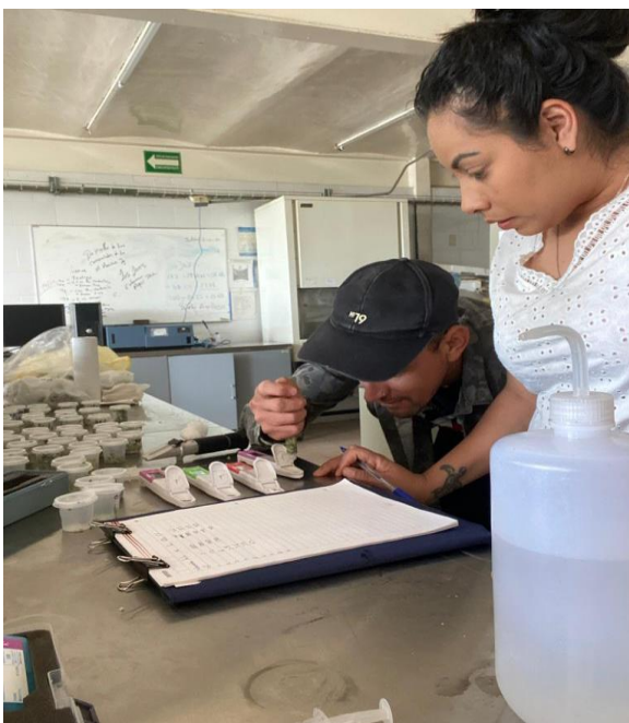
Figura 27: Toma de datos Conductividad Eléctrica, K, NO 3 , Ca.
