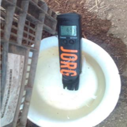
Figura 14: Medición con conductividad con potenciómetro.
