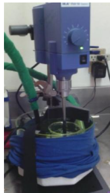
Figura 11. Montaje experimental para la dispersión de nitrato de plata.
