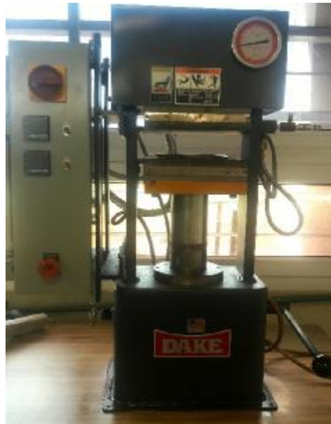
Figura 2.4 Prensa hidráulica empleada en la preparación de placas.
