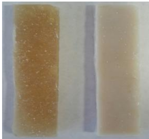
Figura 2.10 Placas obtenidas de las cuales se obtuvieron las muestras para DMA.
