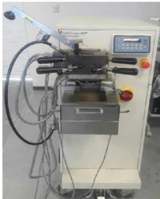
Figura 2.2 Cámara de mezclado empleada en la preparación de los materiales.
