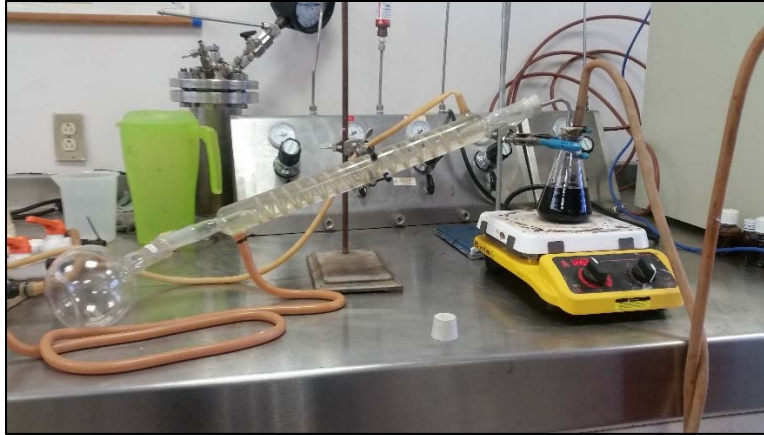
Figura 3.10 Sistema de destilación de solvente de asfaltenos
