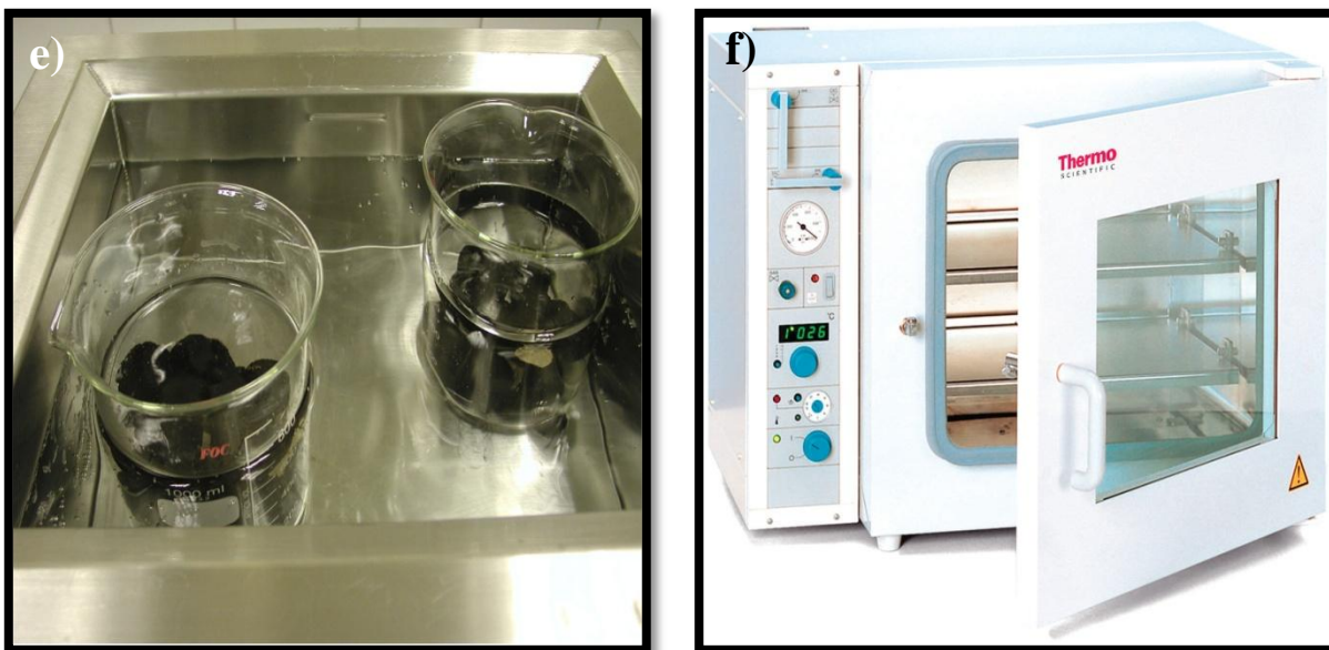
Figura 2.1.- Resumen en imágenes del proceso de oxidación del grafito. (a) Mezcla de H_2SO_4 y grafito en baño de hielo. (b) Incorporación de KMnO_4 y reacción por 2 h a 0\text{ }^\circ\text{C} . (c) Reacción oxidativa a 35\text{ }^\circ\text{C} por 2 h. (d) Aislamiento y lavado del grafito oxidado. (e) Proceso de ultrasonido. (f) Secado.
