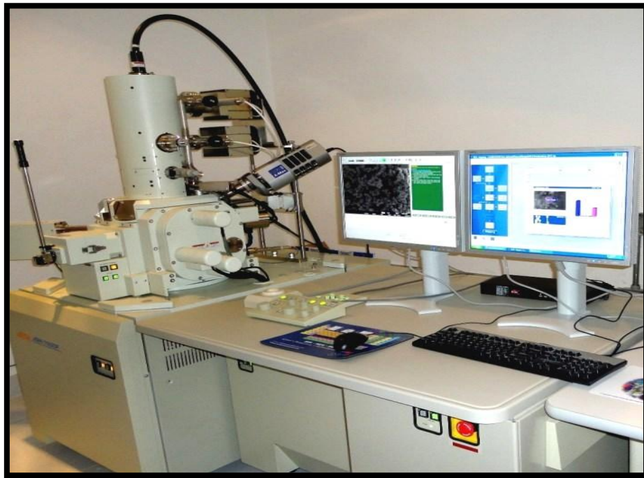
Figura 2.4.- Microscopio de barrido electrónico JEOL JS-7600F
