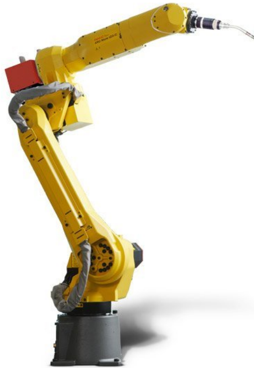
Figura 3.3 Robot FANUC Arc mate 12ic utilizado para la soldadura de las uniones del acero experimental HSLA al Cr-Ni, [41].
