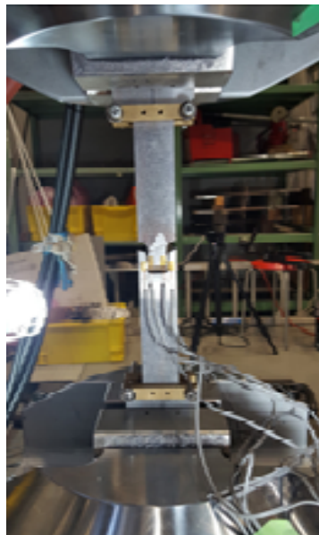
Figura 1.6 Máquina MTS donde realizaron las pruebas de tensión uniaxial de tres probetas en acero SM490 [4]
