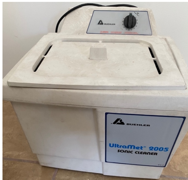
Figura 3.7 Equipo ultrasónico modelo ultramet 2005 de la marca Buehler utilizado para la limpieza de las probetas fracturadas.
