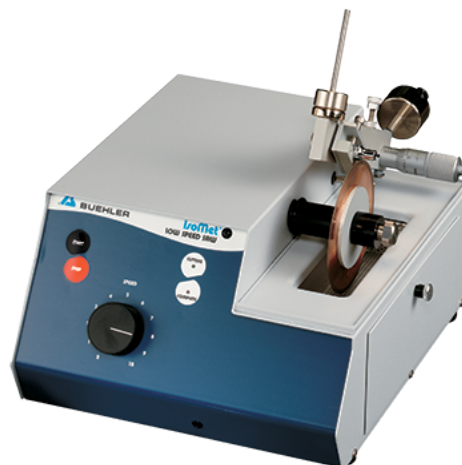
Figura 3.6 Maquina de corte por disco abrasivo marca Buehler IsoMet, utilizada para realizar el corte de probetas seleccionadas [46].
