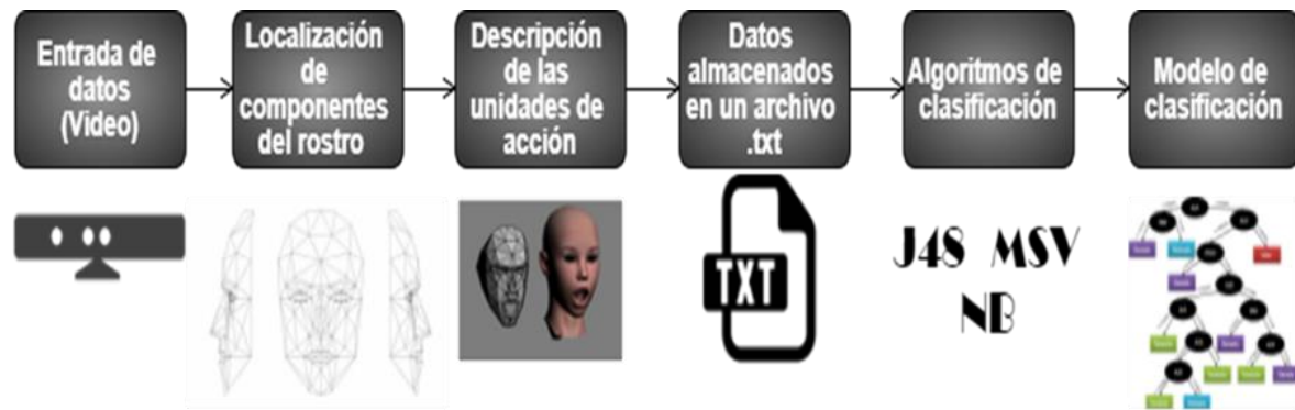
Figura 2.9 Esquema de funcionamiento para la etapa de entrenamiento del sistema de reconocimiento de expresiones faciales.
