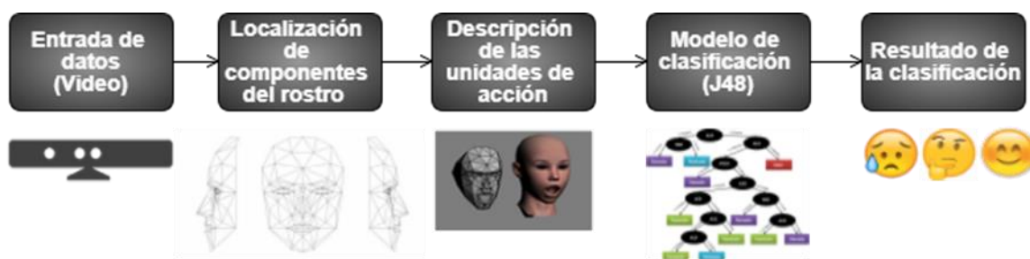
Figura 2.10 Esquema de funcionamiento para validar los modelos de clasificación para el sistema de reconocimiento de expresiones faciales (Etapa de prueba).
